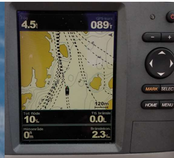
GPS-plottern: Förbrukning 10 % per timme eller 2.3 % per distansminut
