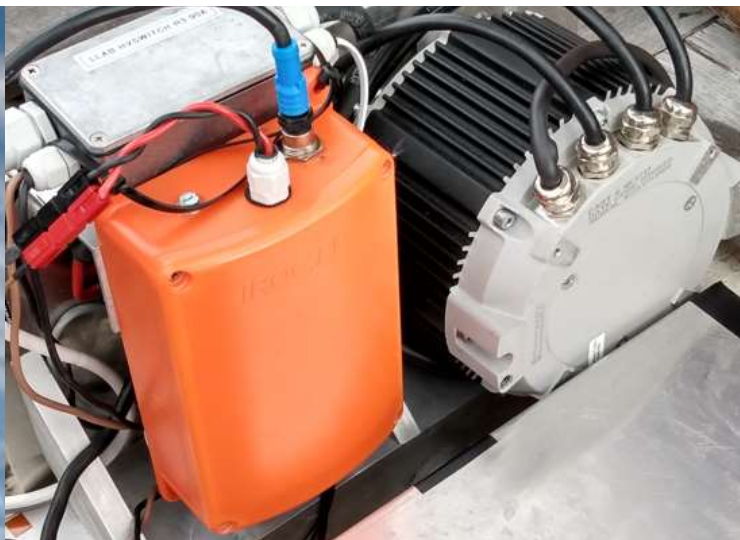
Installation i elsnipa med 4 kW elmotor och två teslamoduler (ca 10 kWh)
